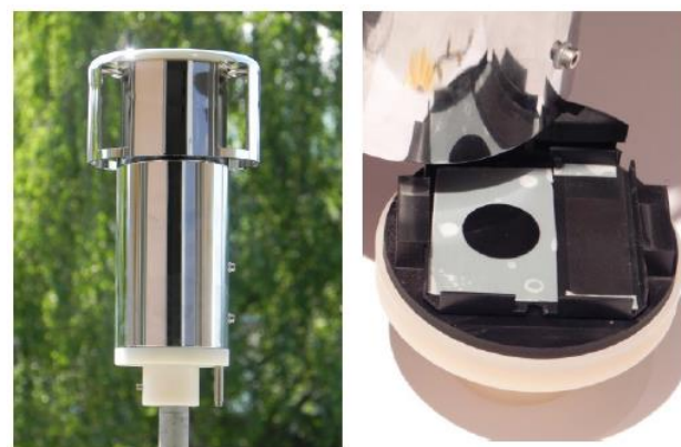
Figure 2 : Illustration du capteur passif de particules PM10
