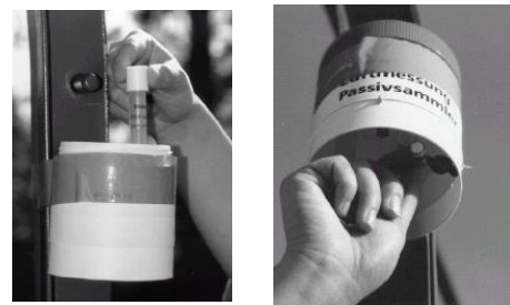
Figure 1 : Illustration de l'installation des tubes passifs, de gauche à droite : NO 2 – Boîte de protection des échantillonneurs
